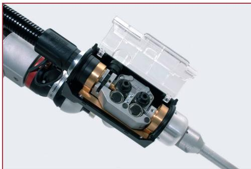
SKS Frontpull-Brennersystem mit PF5-Technik
